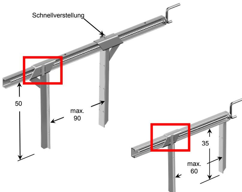
Die Layher Schalzwinge 90/50 und 60/35 – unentbehrliche Helfer für alle Schalarbeiten länglicher Bauteile auf jeder Baustelle.
